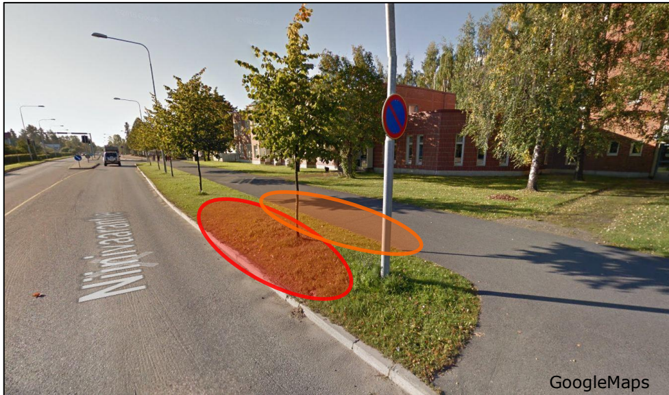
Kuva 94. Pysäkkisyvennyksen ja odotustilan likimääräinen sijainti. Jalankulku- ja pyöräilyväylää tulee siirtää lähemmäs kiinteistön rajaa, jotta pysäkkialue mahtuu Niinivaarantien varteen.
