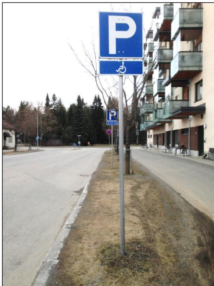
Kuva 149. Senioripihan le-pysäköintipaikat sijaitsevat ajoväylällä korkean reunatuen ja ruohokaistan takana, minkä vuoksi saattoliikenne pysäköi usein jalankulku- ja pyöräilyväylälle sisäänkäyntien eteen.
